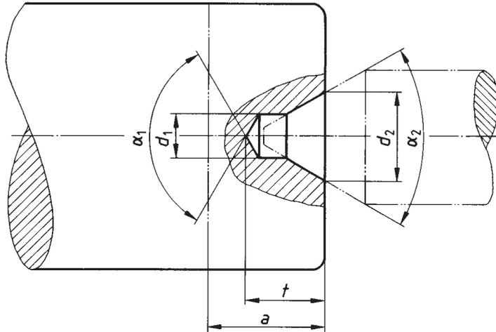
Bezeichnung einer Zentrierbohrung 60°, mit geraden Laufflächen, ohne Schutzsenkung (A), mit Durchmesser  $d_1 = 4$  mm und Durchmesser  $d_2 = 8,5$  mm:
