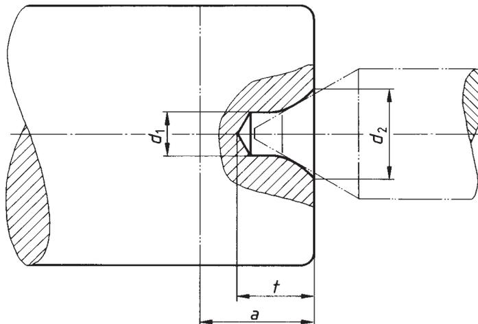
Bezeichnung einer Zentrierbohrung 60°, mit gewölbten Laufflächen, ohne Schutzsenkung (R), mit Durchmesser  $d_1 = 4$  mm und Durchmesser  $d_2 = 8,5$  mm:
